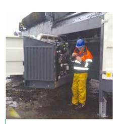
Herausschwenkbarer Motorträger für optimalen Zugang bei Wartungsarbeiten
